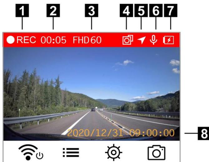
После того как двигатель автомобиля будет заведен, DrivePro автоматически начнет запись видео. По умолчанию, каждую 1 минуту видеорегистратор сохраняет отдельный видеофайл. Настройка длительности записи описана в разделе **«Настройки»** (Settings) данного руководства.
