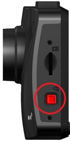
**Создание экстренных записей в ручном режиме:** во время видеозаписи нажмите кнопку аварийной записи на левой стороне передней панели фронтальной камеры, чтобы вручную активировать режим аварийной записи. Камера заднего вида также автоматически войдет в режим аварийной записи, что будет подтверждено миганием оранжевого индикатора.
